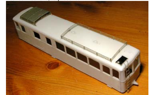
Présenter les aérateurs, repercer les trous si nécessaire.
